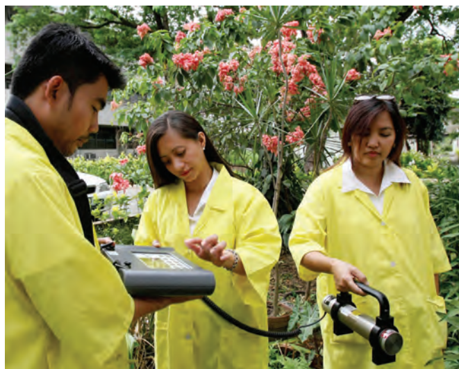
FIGURE 7 La recherche scientifique d'aujourd'hui nécessite des équipements complexes et des ordinateurs. Ces scientifiques utilisent un spectromètre gamma portable pour mesurer les niveaux de rayonnement gamma près de Quezon City aux Philippines. (Bullit Marquez/AP photo.)
