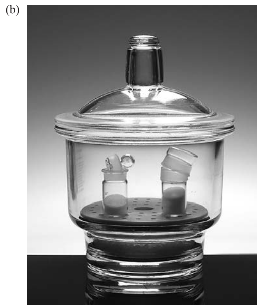
Figure 2-8 (a) Composantes d'un dessiccateur. La base contient un agent chimique desséchant et est généralement couverte d'une grille ou d'une plaque en porcelaine percée de trous qui supporte les pèse-filtres ou les creusets. (b) Photo d'un dessiccateur contenant des pèse-filtres avec des solides secs.
